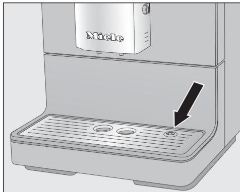
Đảm bảo nắp khay hứng nước được lắp đúng cách (xem hình minh họa). Vệ sinh khu vực bên dưới khay đựng cà phê máy. Nước có thể chảy vào bên dưới thiết bị khi khay hứng nước được tháo ra.
